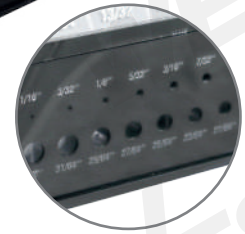
Medidor de brocas
